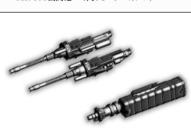
Bf 109 G-14は固定武装として、機首上面のパイロットの視線に近い位置にMG 131機銃×2挺と、エンジン内にモーターカノンを持つ。MG 131機銃は電動で装填・発射され、徹甲弾、破片弾、榴弾、焼夷弾などさまざまな弾薬を発射可能。連合国が使用した同時代の50口径機関銃と比較して口径がやや大きく、軽量で発射速度が速いため、空中目
