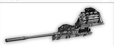
「Hs 129」の固定武装として、通常は主翼の付け根にMG 17/7.92mm機銃×2挺と、胴体側面にMG 151/20mm機銃×2挺を持ち、その他、主翼および胴体下面には最大300kgの爆装も可能で、胴体下面に は様々な兵装オプションが想定された。「タンクバスター」としてさらに特化した「B-3」では、主翼の付け根 にMG 17/7.92mm機統×2挺(本キットで採用のマーキング機体では非搭載)と、胴体下面に航空機搭載 用のBK 7,5/75mm対戦車砲×1門を固定武装とし、BK 7,5の巨大なドラムマガジンを胴体内に収納する ため胴体側面のMG 151は非搭載とされた。本機搭載のBK 7,5は、12発の75mm砲弾を収納した大型の ドラムマガジンを採用し、電磁空気制御による自動装填式を実現。重量700kgにも達するこの巨砲は機体 を鈍重にした反面、その威力はすさまじく、スターリン戦車を一撃で葬る威力があったと言われている。
