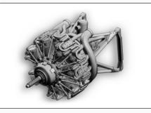
当初、非力なアルグス「As 410 A」空冷倒立V型エンジン(離昇出力459hp) だったが、占領下のフランスで、ノーム・ローン「14 M 14気筒複列星型空冷エン ジン(離昇出力700hp)の生産に目処が立ったため、急遽、このエンジンを搭載 した「Hs 129 B」が量産される事となった。まだ出力不足ではあったものの、ア ルグス「As 410 A」と比べると、直径950mm、重量400kgというコンパクトなが らも格段の性能向上を示した。
