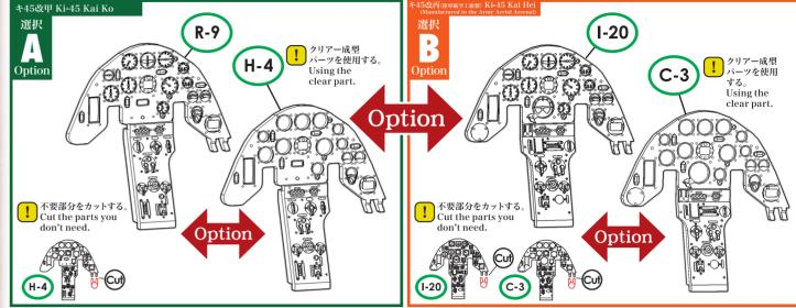
R-9・I-20 使用時の計器整着色方法 How to finish the instrument panel using gray part R-9 or I-20
