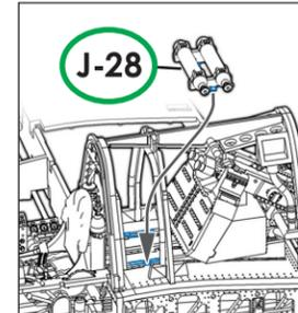
実機におけるパーツ名 Name of the parts implemented in the actual aircraft. J-28 酸素ボンベ Oxygen Tanks
