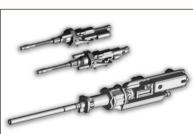
Bf 109 G-14は固定武装として、機首上 面のパイロットの視線に近い位置に MG 131機銃×2挺と、エンジン内に モーターカノンを持つ。MG 131機銃は 電動で装填・発射され、徹甲弾、破片弾、 榴弾、焼夷弾などさまざまな弾薬を発射 可能。連合国が使用した同時代の50口 径機関銃と比較して口径がやや大きく、 軽量で発射速度が速いため、空中目標
