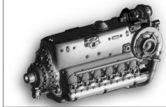
DB 605エンジンは、ボッシュ製の燃料噴射装置を搭載し、燃料供給に支障をきたすことなく 完全な曲技飛行、倒立飛行、急降下を可能にした。単段の可変速遠心式スーパーチャージャー は気圧制御で、あらゆる高度で最適な出力を確保した。このエンジンは比較的コンパクトな 形状と寸法であったため断面が小さくなり、搭載した航空機はかなり流線形の形状を持たせ ることができた。また、シリンダーが逆V字型に配置されているため、パイロットの視線に近い エンジン上部に武器を搭載することができ、射撃精度を向上させることができた。
