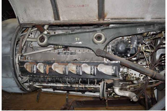
実機の Jumo213E エンジン: エンジン架は右側が吸気口を避けて湾曲していたのに対し、こちらはストレート。 排気管の並びや補器類もぜひキットと見比べてみてください。
