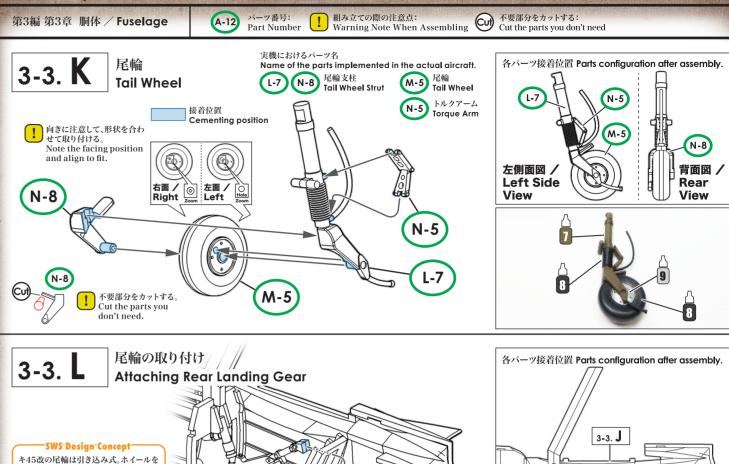
挟むフォークとそれを支える緩衝装置付 きの支柱から成る。尾輪が引き込まれる 時はパーツN-15の縦の部分が伸びて
