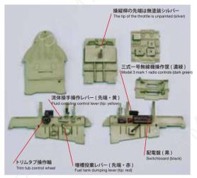
コクピット:震電のコクピットは頑丈なメインフレームの上に乗っかるように搭載さ Cockpit: The Shinden's cockpit was installed atop the robust main れている。左右壁と胴体外板の間には操縦系統のリンクなどが通る、先進的な配置 れている。左右壁と胴体外板の間には探板糸統のリンクなどが通る、先進的な配置 cockpit walls and the outer panels, making for a very advanced design. An oxygen tank was equipped behind the seat, and the rear of the 主翼と結合する胴体第15番バルクヘッド(隔壁)となっている。
